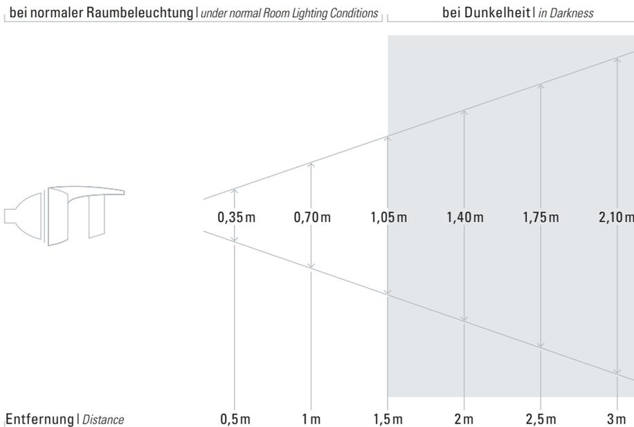
Die empfohlene Reichweite von GoboTop beträgt 1,5 Meter bei normaler Beleuchtung und 3 Meter bei Dunkelheit. Dabei wird der Durchmesser der Projektion mit zunehmender Entfernung größer.
